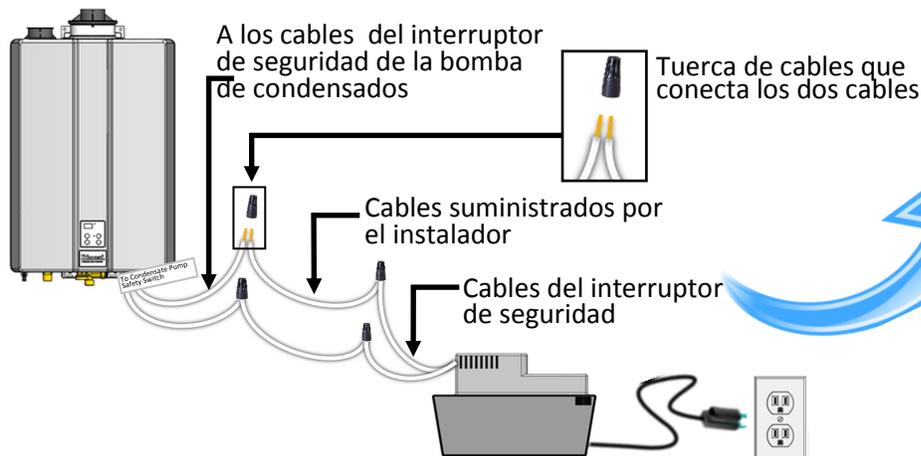
La bomba de condensados (suministrada por el instalador) incluye un interruptor de seguridad interno y un cable eléctrico. El cable eléctrico debe estar conectado a la fuente de alimentación.
