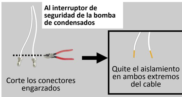
5. Con tuercas para cables u otros conectores de cable aprobados, conecte los cables de “Al interruptor de seguridad de la bomba de condensados” a los contactos regularmente abiertos en la bomba de condensados (vea la imagen más abajo).
