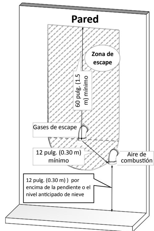
No se permite colocar la terminación del aire de combustión en el área sombreada
